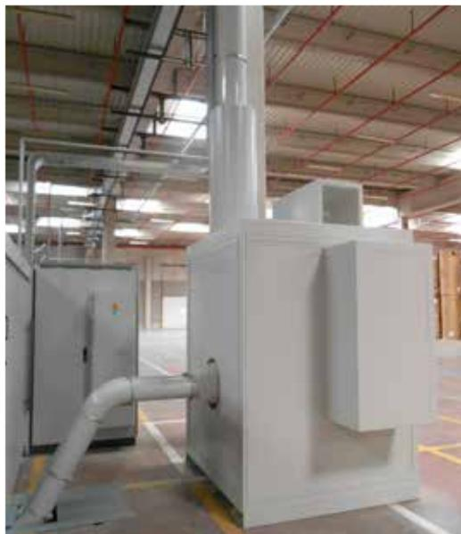
Deviatore in robusta costruzione per indirizzare scarti su più punti di scarico in funzione della tipologia di materiale
