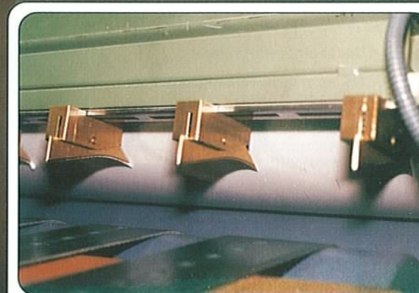
Abstreifnadeln: verhindern, daß sich der flexible Karton um die Leim-Auftragwalze wickelt. Stripping needles: strip off the flexible carton from the glue application-roller.
