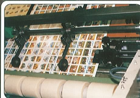
Vordermarken halten zunächst beide Bögen an, Zieh- bzw. Schiebemarken richten sie seitlich aus. First of all front lays stop both sheets, pull lays and push guides align them lateral.
