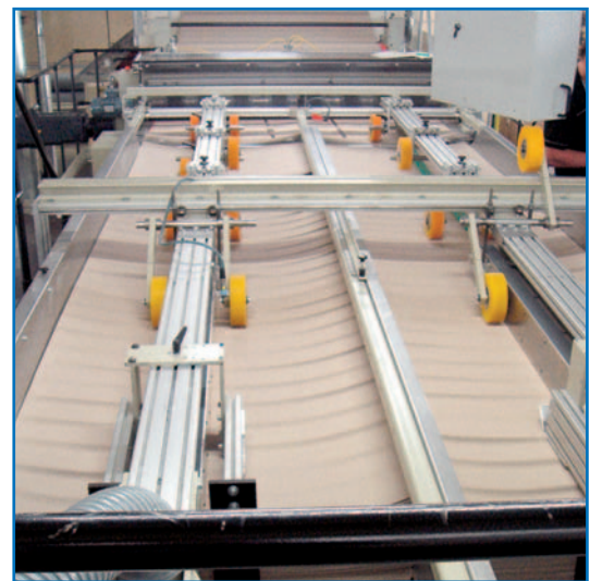
Schuppenstation: zum Überschuppen der Bogen für den sauberen Transport in den Nonstop-Stapelableger, sowie einer akkuraten Stapelbildung. Vorgesehen für 2-Nutzen-Betrieb. Offene Seite der Wellpappbogen ist immer oben. overlapping (shingling) station for preparing the single face corrugated sheets to be delivered to the automatic non-stop down-stacker suitable for two-up production – open flute up
